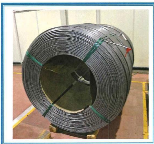
ลวดอลูมิเนียมขนาดเส้นผ่าน ศูนย์กลาง 3.2-25 มิลลิเมตร (Aluminium Wire)
