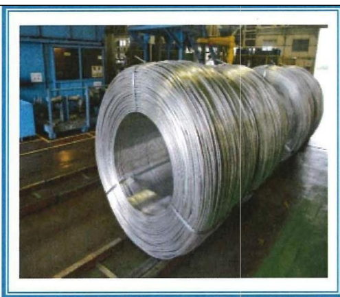
เส้นลวดอลูมิเนียมขนาดเส้นผ่าน ศูนย์กลาง 9.5-25 มิลลิเมตร (Aluminium Wire Rod)
